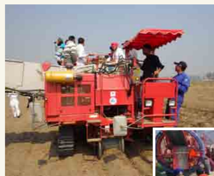
インド仕様で改良されたジャガイモ収穫機を実際に動かしてみる農家の人たち。
